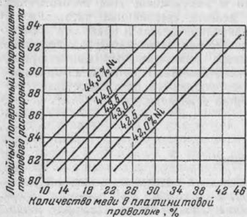
Рис. 8-3. График зависимости линейного поперечного коэффициента расширения платинита от содержания никеля и меди.
