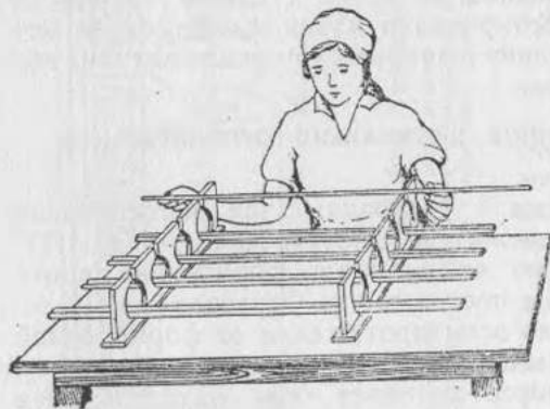
Рис. 5-22. Калибровка дротов по диаметру.
