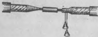
Рис. 5.18. Ступенчатая разделка бумажной изоляции
