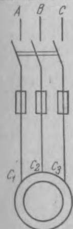
Рис. 7.9. Схема пуска двигателя рубильником
